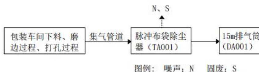
图 33 包装车间下料、磨边、打孔过程废气处理工艺流程及产排污节点图
