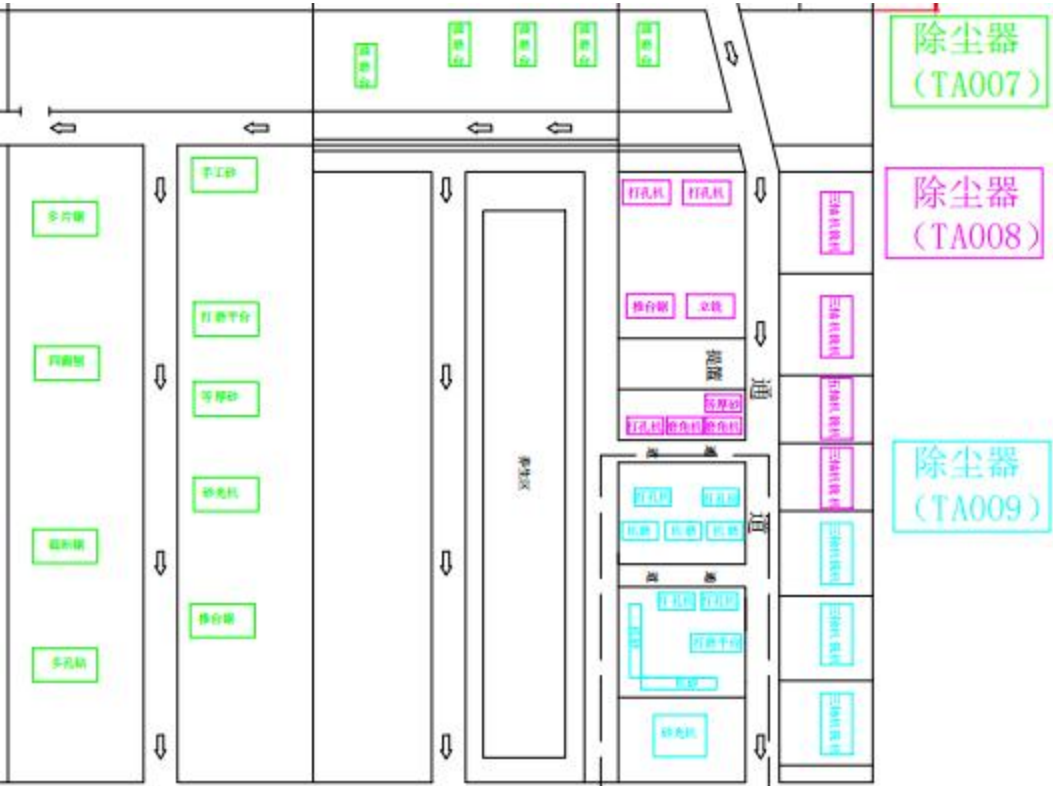
图 45 脉冲布袋除尘器收集的生产设备废气示意图
