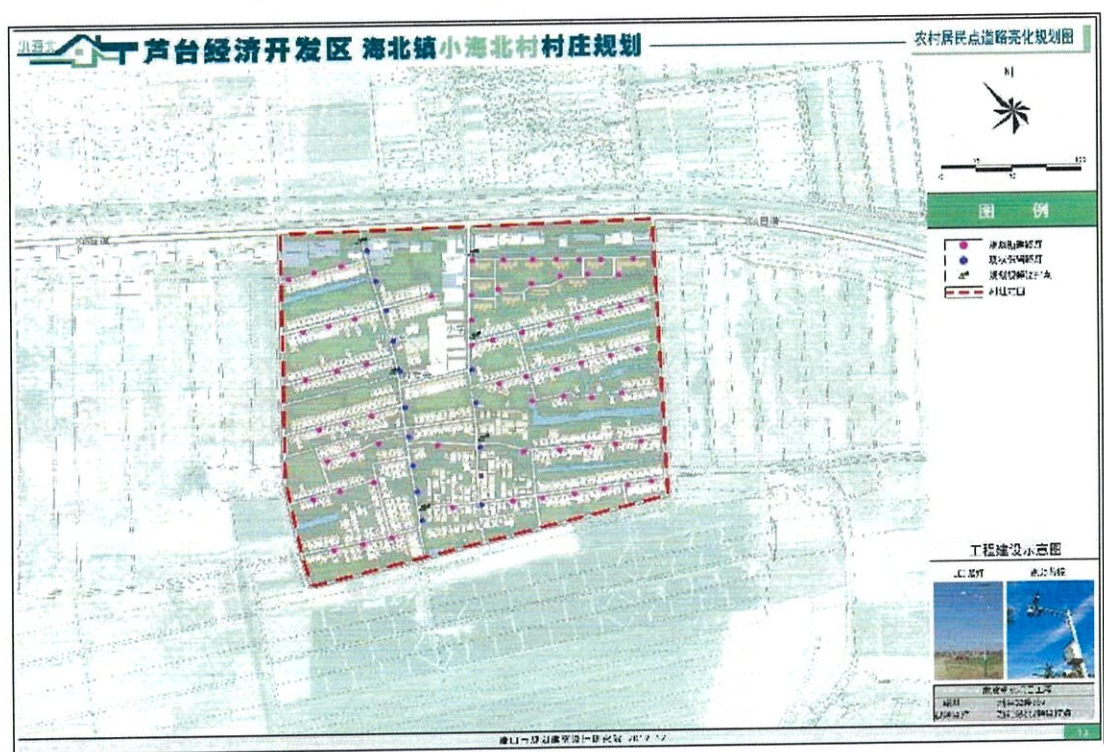
(13) 农村居民点道路亮化规划图: 根据规划图, 村内规划新建路灯 67 个, 规划视频监控点 6 个, 详见下图:
