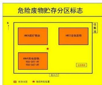
说明：A. 标志颜色：危险废物分区标志背景色应采用黄色，RGB 颜色值为（255， 255， 0）。废物种类信息应采用醒目的橘黄色，RGB 颜色值为（255， 150， 0）。字体颜色为黑色，RGB 颜色值为（0， 0， 0）。
